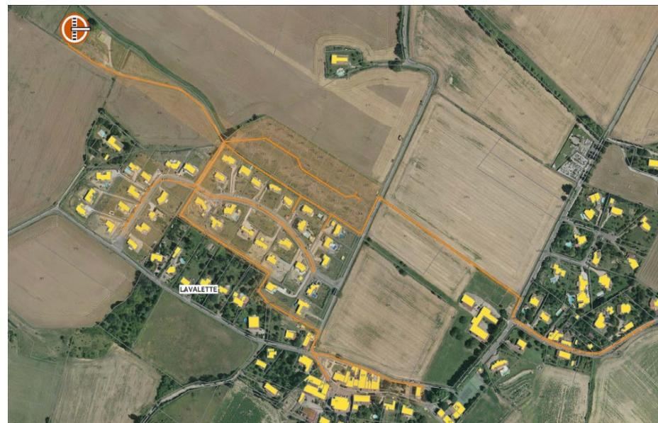
Figure 78 : Réseau assainissement collectif, source : Réseaux 31
